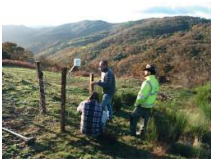
Photo 14. Dispositif de mesures des micro-topoclimats avec des piles météorologiques boutons, intégré dans un dispositif construit au CEFE
