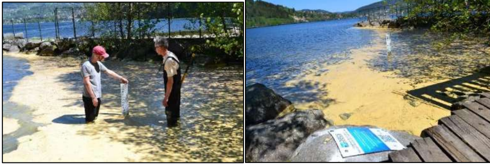
Illustration.4 : Pose d'échelles limnimétriques.
