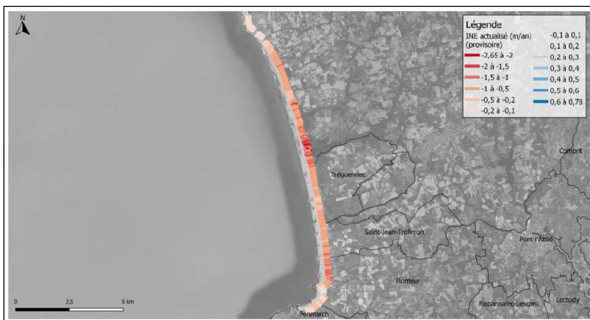
ANNEXE 10 : INE ACTUALISE AU DROIT DES COMMUNES DE TREGUENNEC, SAINT-JEAN-TROLIMON, PLOMEUR ET PENMARC'H ENTRE 1952 ET 2018 (EGIS, 2024)
